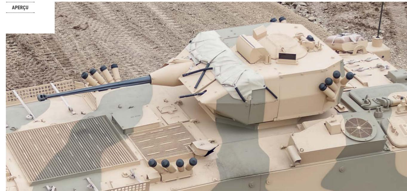
**La SABER est une tourelle motorisée monoplace de moyen calibre qui peut être installée sur des véhicules blindés à roues ou chenillés.**
